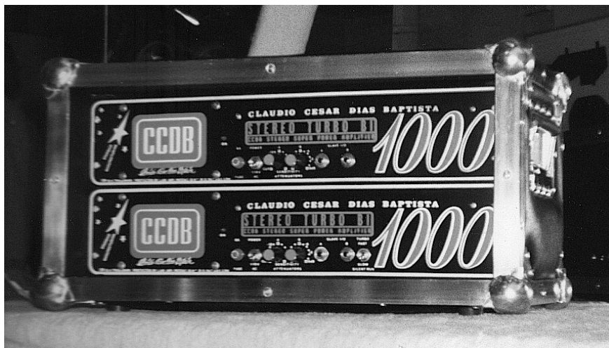
Foto 22 - Rack com dois amplificadores CCDB BI 1000. Cada amplificador contém duas seções de potência de 500W RMS cada
