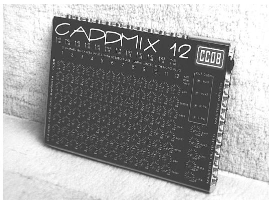
Foto 34 - Mesa de gravação CCDB FLIGHTSTUDIO Input-Output Modules. Esta mesa contém chaveamentos eletrônicos e um circuito lógico, o qual permite ao operador mudar com um só toque, numa de três chaves no módulo mestre, todo o funcionamento do aparelho, conforme as etapas do processo de gravação, acelerando-o muito e evitando erros
