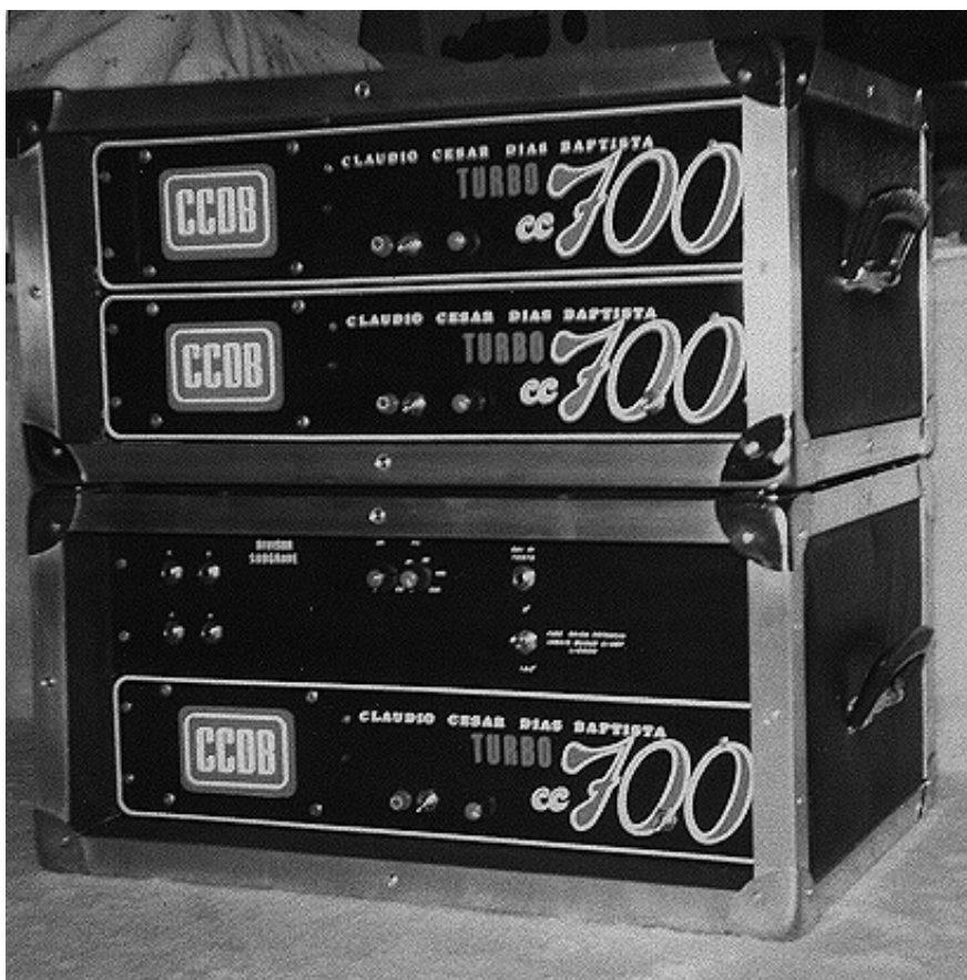
Foto 20 - Rack com 2 amplificadores CC700 (em cima), com resposta até corrente contínua; e rack com um CC700 e filtro para subwoofer (embaixo)
