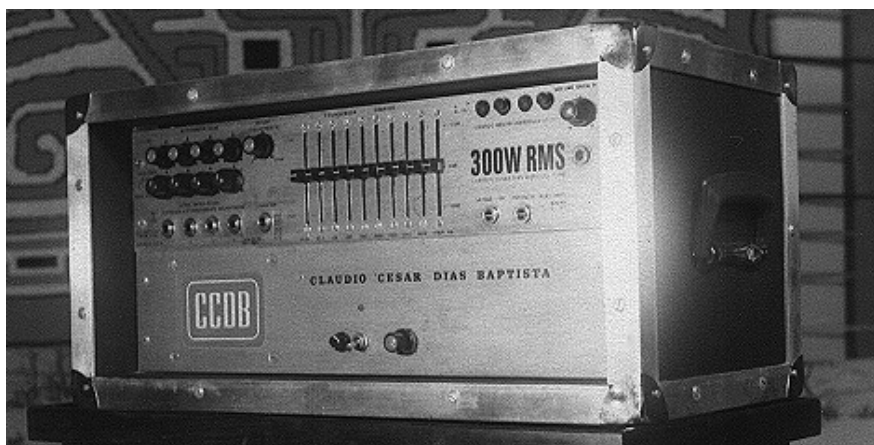
Foto 24 - Antigo amplificador CCDB de 300W RMS, com pré, para instrumentos musicais e vozes, donde saíram os lendários amplificadores Turbo-Compressor CCDB, capazes de amplificarem, sozinhos, toda uma banda
